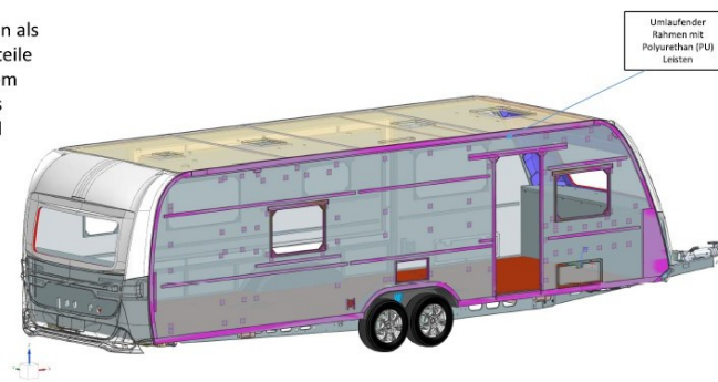
Darstellung Strukturbeuteil Bug und Heck aus LFI
